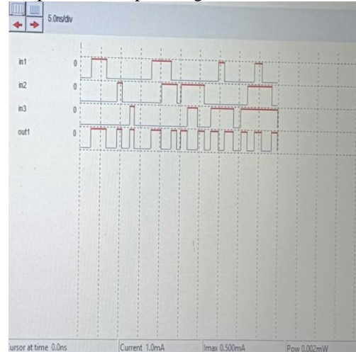
Fig:2 output for 3 input Xor gate
